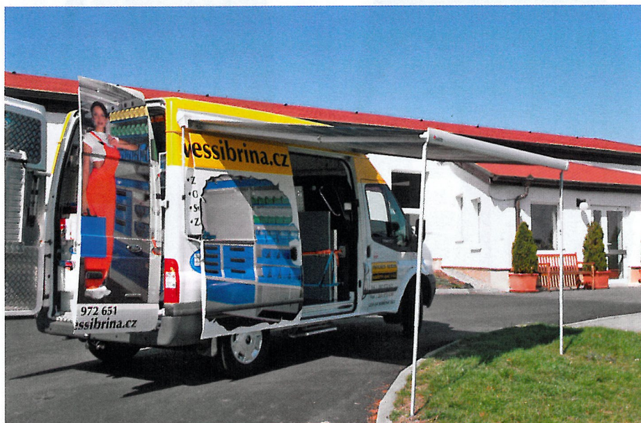
Díleňská nástavba na podvozku Ford Transit s roztaženou pergolou
